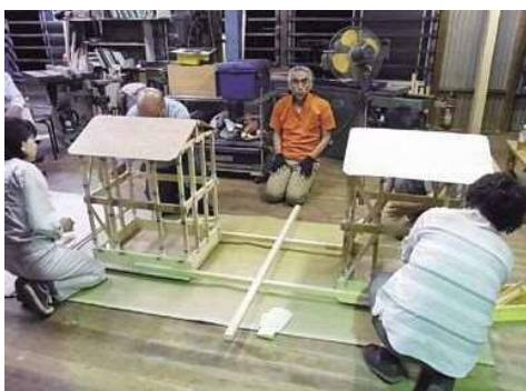
(2台の倒壊模型を連結した様子)
