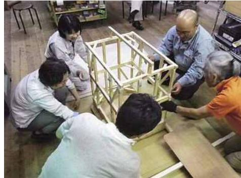
(倒壊模型に筋交い等を付けるピット作業)
