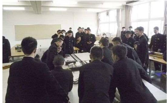
いよいよ各班の橋におもりを乗せて計測実験。計測前に各班に①何枚載せられるかの予想と②どこが壊れそうかの推測を発表してもらい、1班ずつ重り（タイル）を載せて計測していきます。
