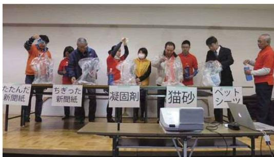
(トイレの吸水実験の注水の様子)
